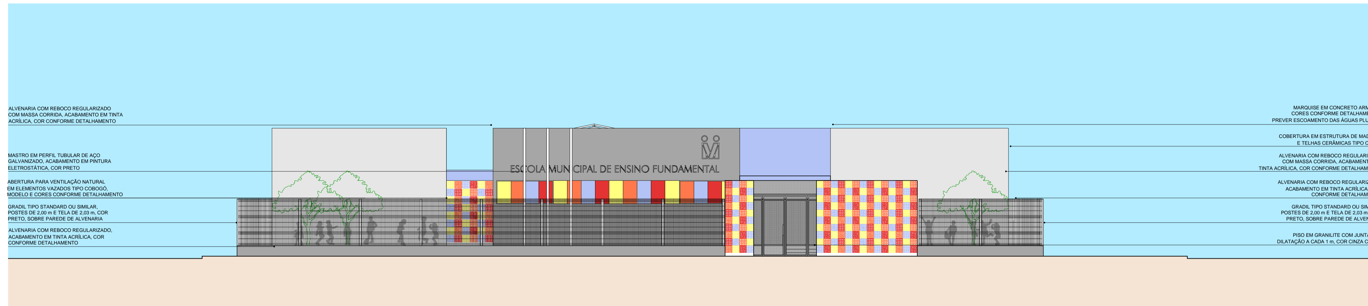
1 FACHADA FRONTAL - VISTA DA RUA ESQ. ESCOLA PADRÃO MUNICIPAL DE ENSINO FUNDAMENTAL ESCALA 1 / 100
